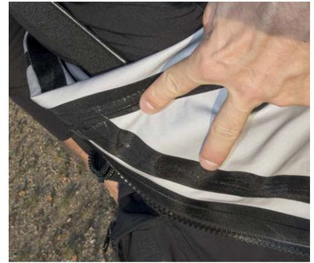
Die große Neuheit der NST-Anzüge verbirgt sich unter diesem Tape-Streifen: eine Schweißnaht.
